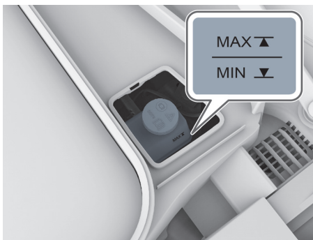
图示：制动液位（检视盖已拆下）
