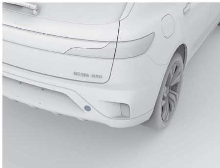
图示：拆下后拖车钩孔堵盖
